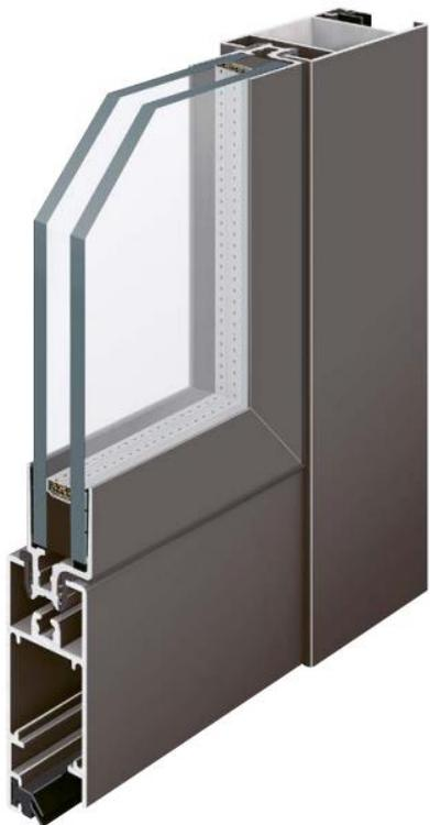
既存のサッシにアタッチメントを付設し、従来の単板ガラスを複層ガラスに交換
