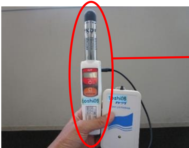
暑さ指数計（WBGT計） （京都電子工業製）
