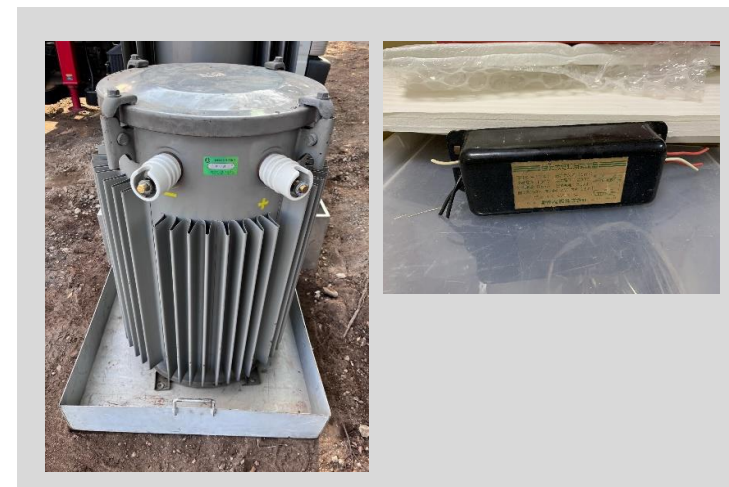
PCB廃棄物(変圧器・安定器)
