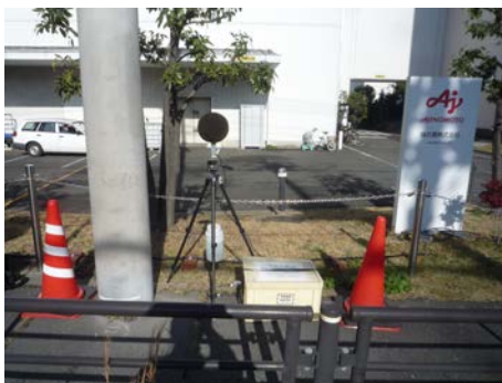
地点 4 (道路交通騒音・振動)
