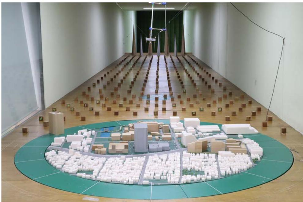
写真4.8.3-1 風洞実験施設・模型の状況（建設後）
