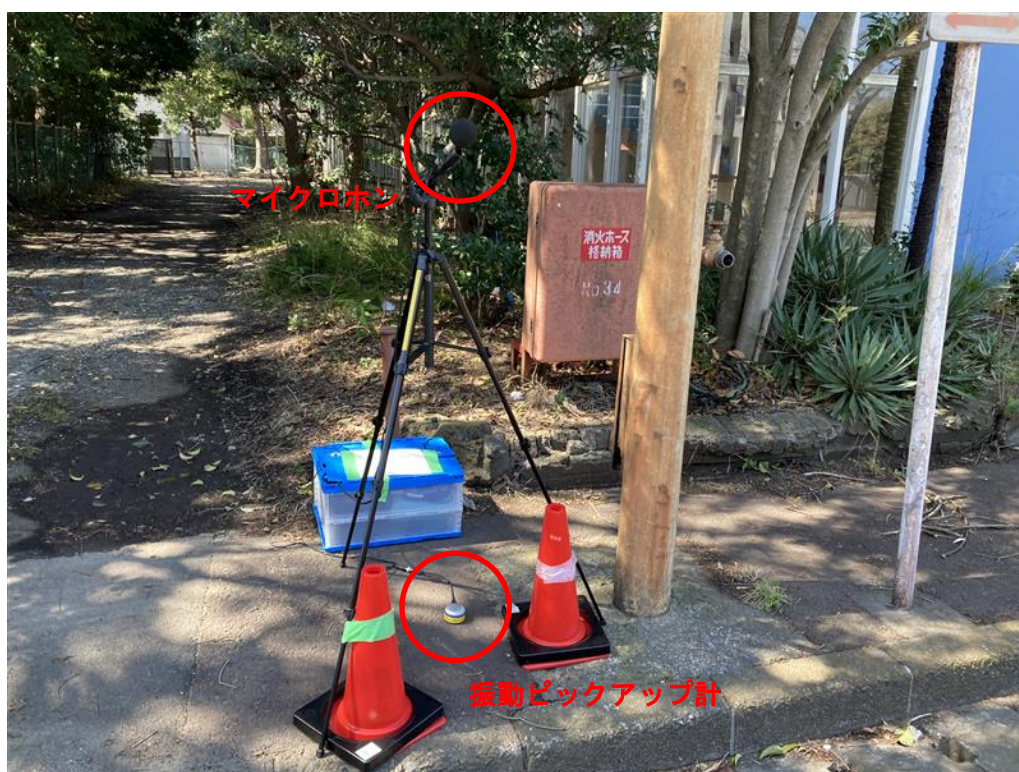
写真 2.1-1 環境騒音・振動現地調査状況（計画地内）
