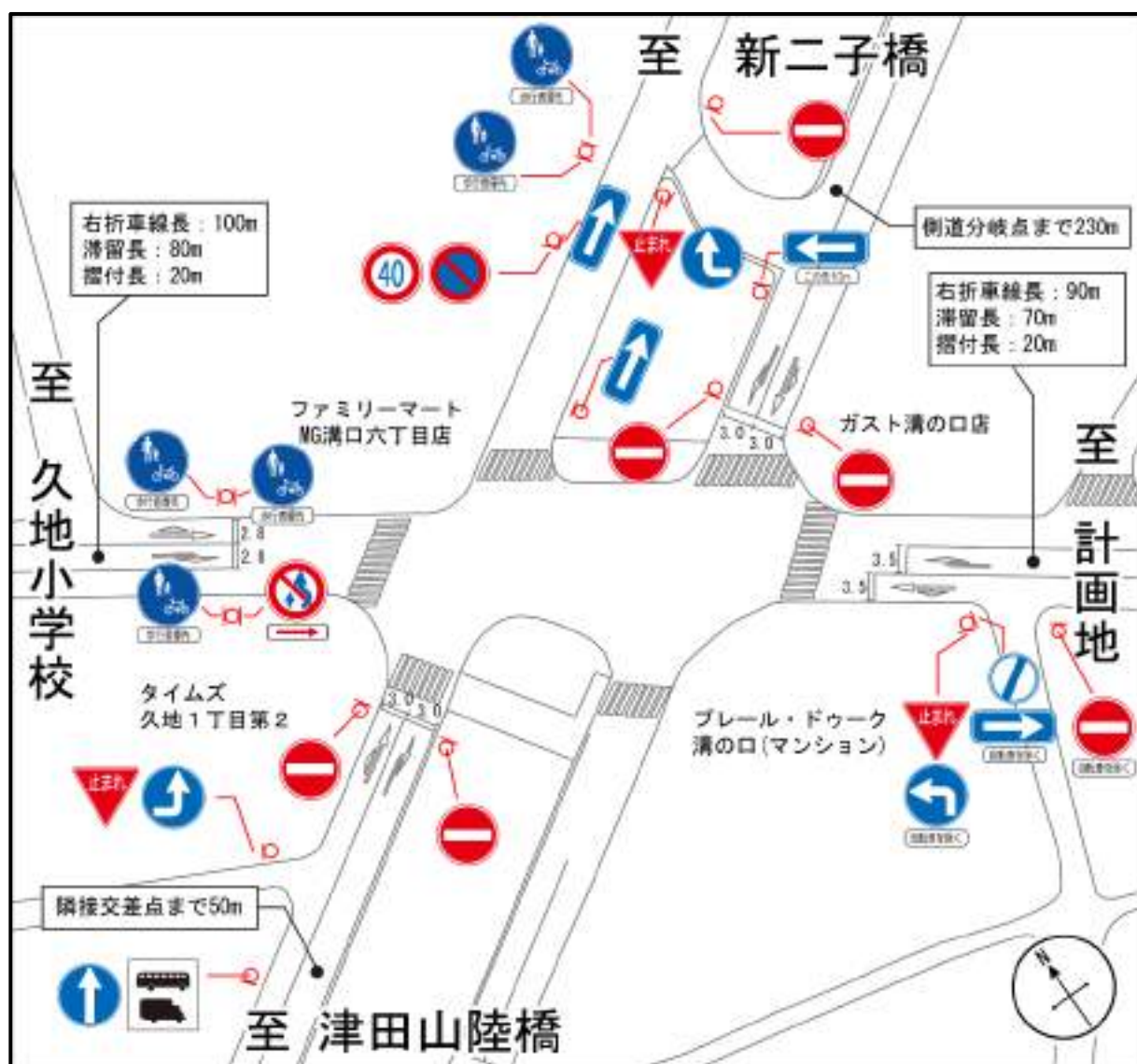
図 4. 8. 1-2(1) 道路幅員及び交通規制の状況 (No.1 溝口交差点)
