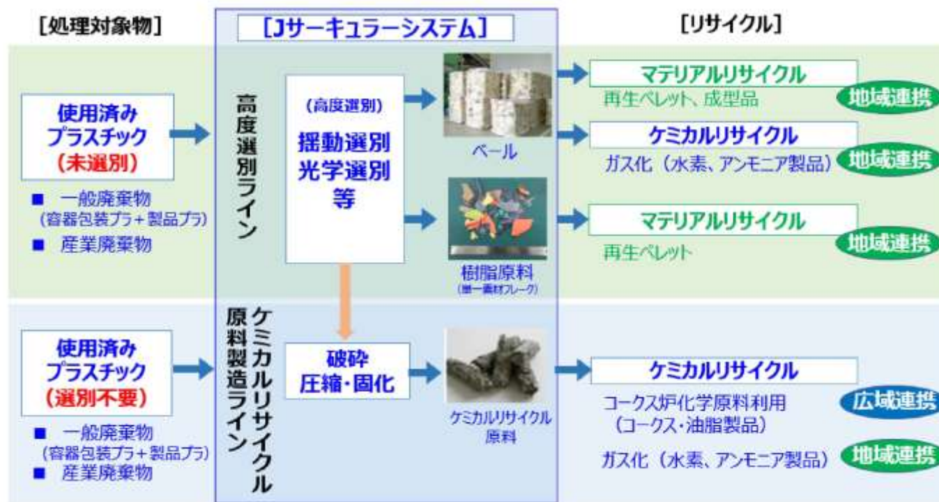
廃プラスチック類のリサイクル処理フローの例
