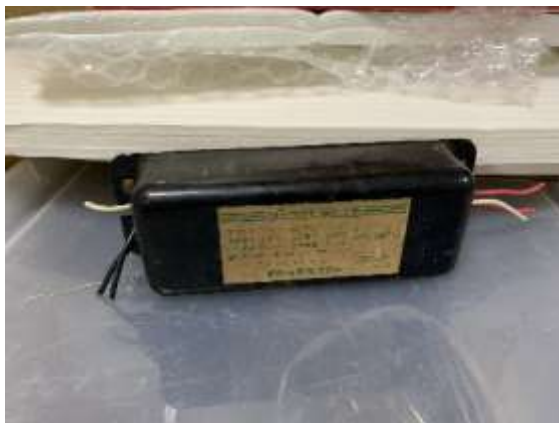
PCB廃棄物（安定器）
