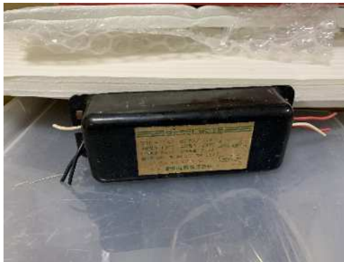
PCB廃棄物（安定器）
