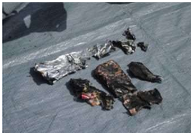
＜リチウムイオンバッテリーの燃え殻＞
