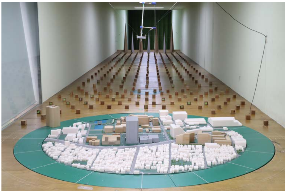
写真4.8.3-1 風洞実験施設・模型の状況（建設後）
