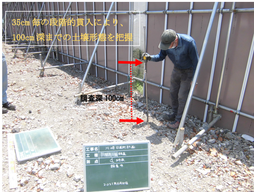
写真 5-1 長谷川式大型検土杖の形状
