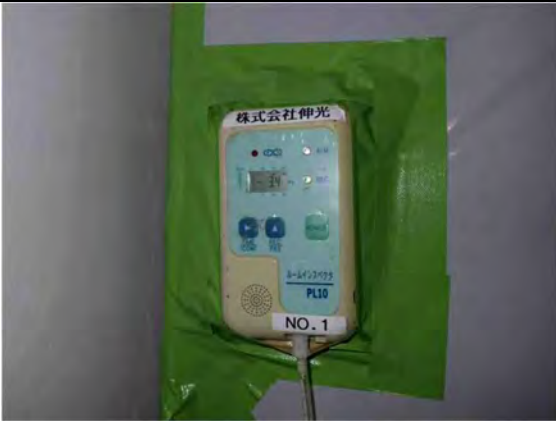
写真7. 漏えい監視装置設置状況
