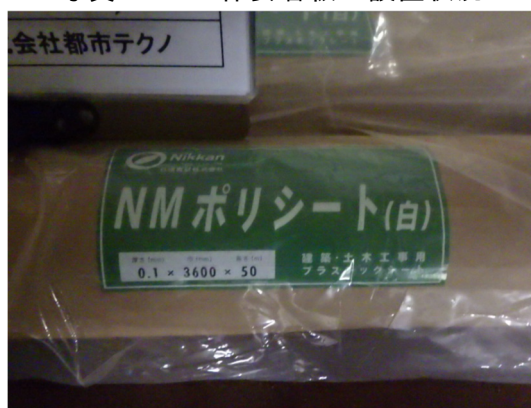
写真 3.1-4 養生時シート (厚さ 0.1mm)
