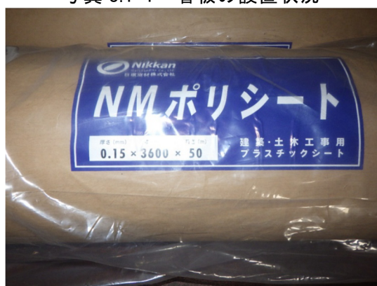
写真 3.1-3 養生時シート (厚さ 0.15mm)
