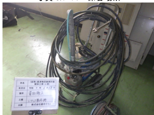
写真 3.1-16 エアレス散布機
