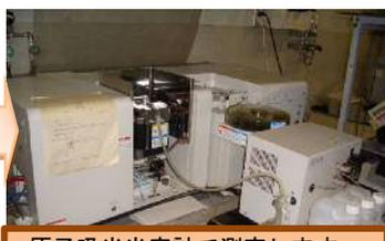
原子吸光光度計で測定します。（夾雑物が多いため、水素化物発生装置を併せて使います）
