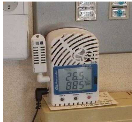
図 1 温度・湿度・CO 2 小型測定器
