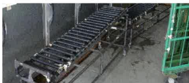
トラックの荷台に可動式のローラーコンベアを設置
