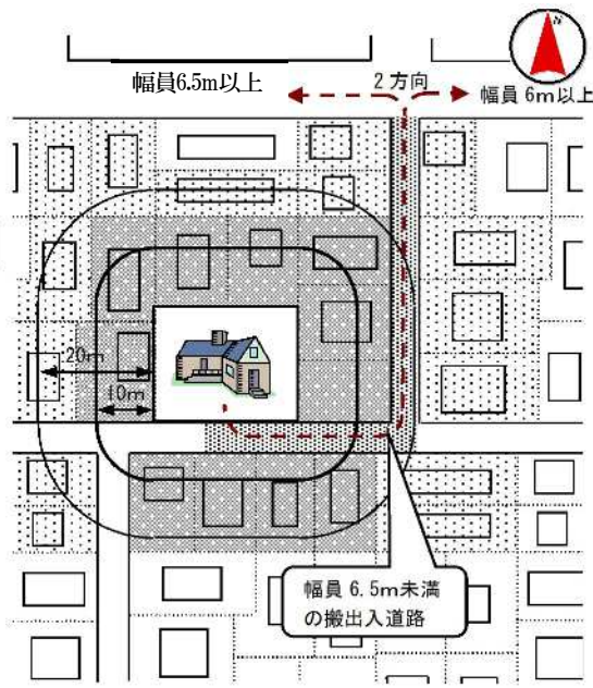
⑤ 規則第2条に定める道路 (幅員6.5m未満の搬入道路)
