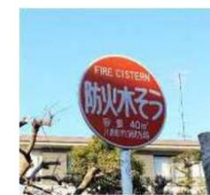
消火活動に必要な水を確保する施設。商業系、工業系の地域では100m間隔、その他の地域では120m間隔を目安に設置されています。※
