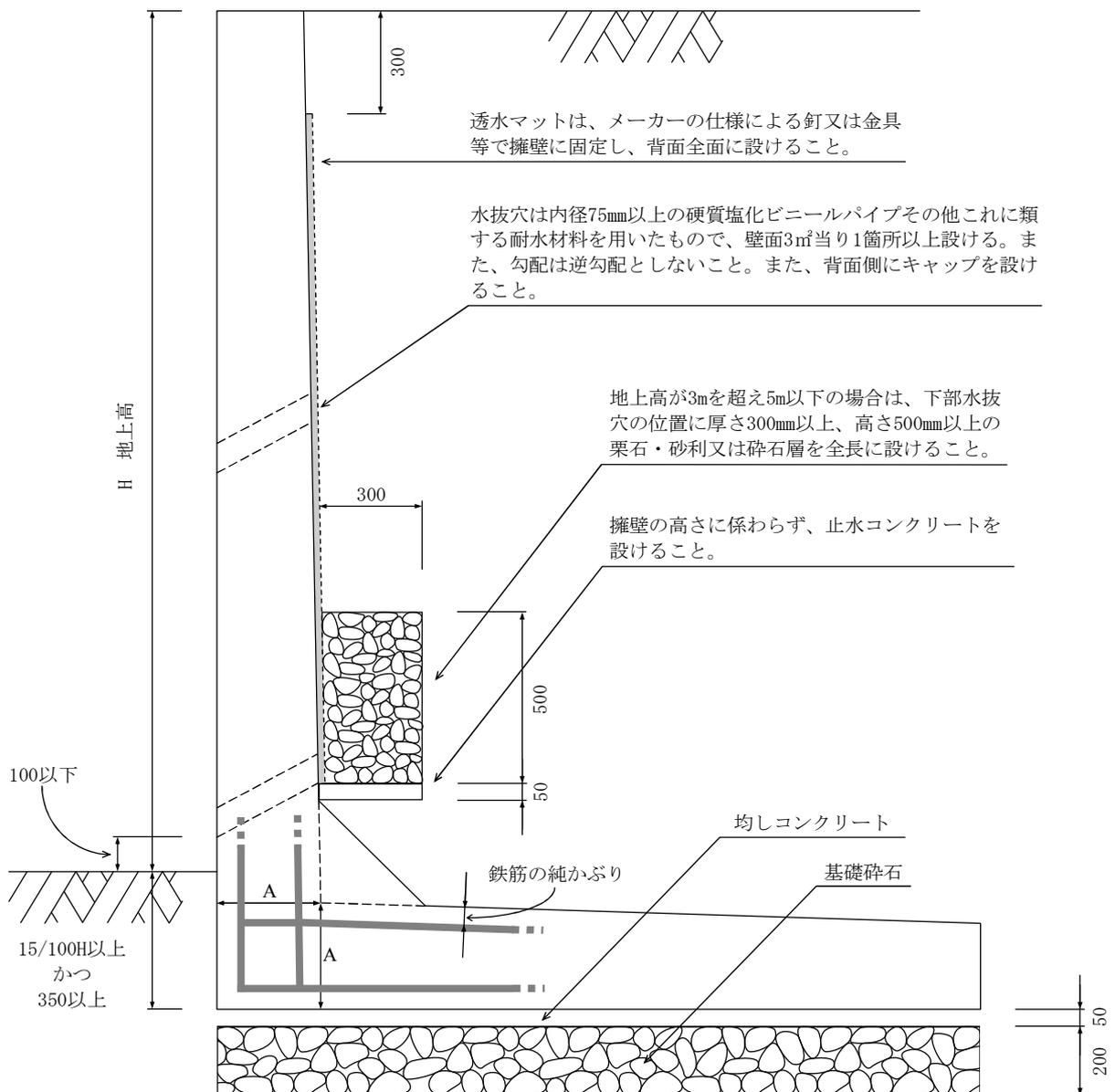
Aの位置において、規定の必要部材厚を確保する（鉄筋のかぶり厚にも注意）
