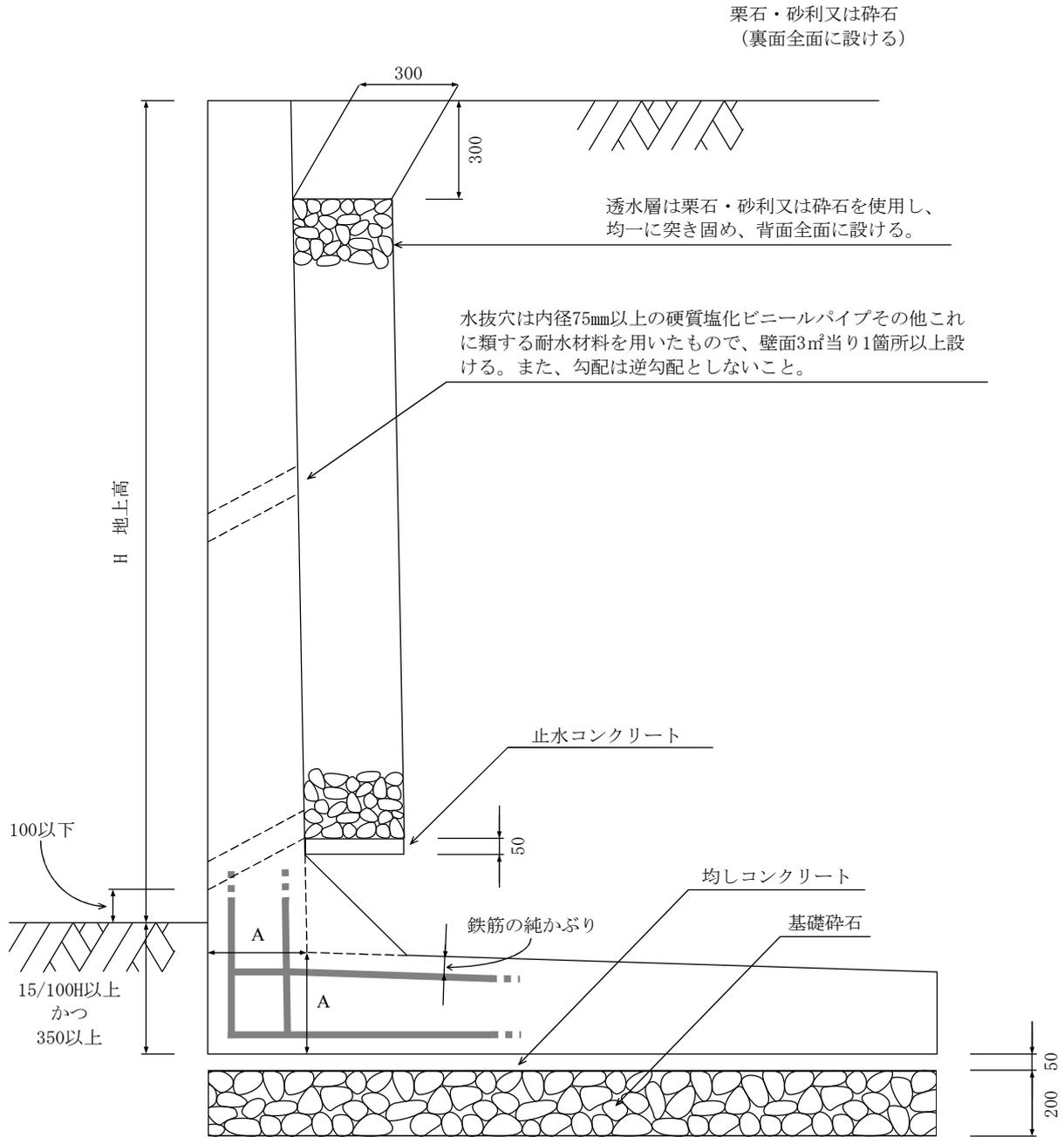
Aの位置において、規定の必要部材厚を確保する(鉄筋のかぶり厚にも注意)
