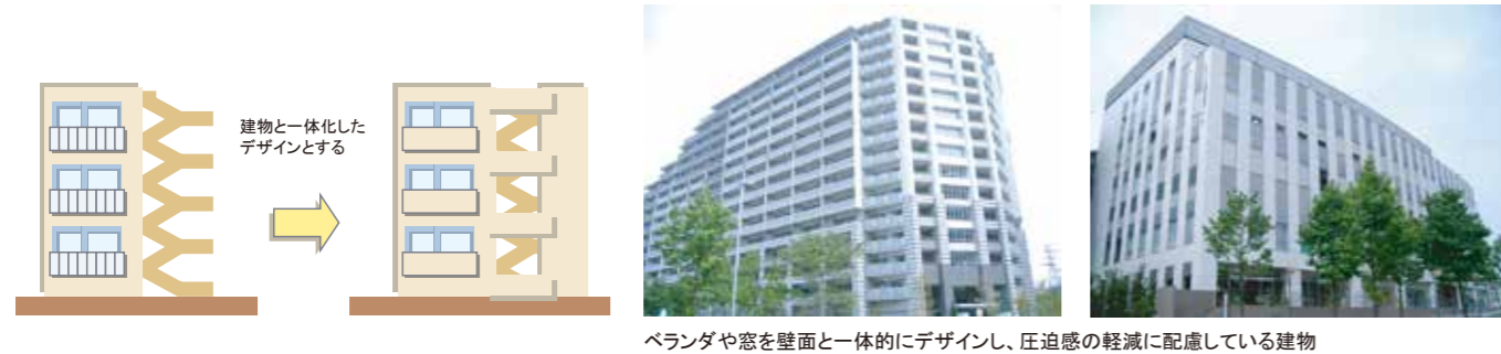
ベランダや窓を壁面と一体的にデザインし、圧迫感の軽減に配慮している建物
