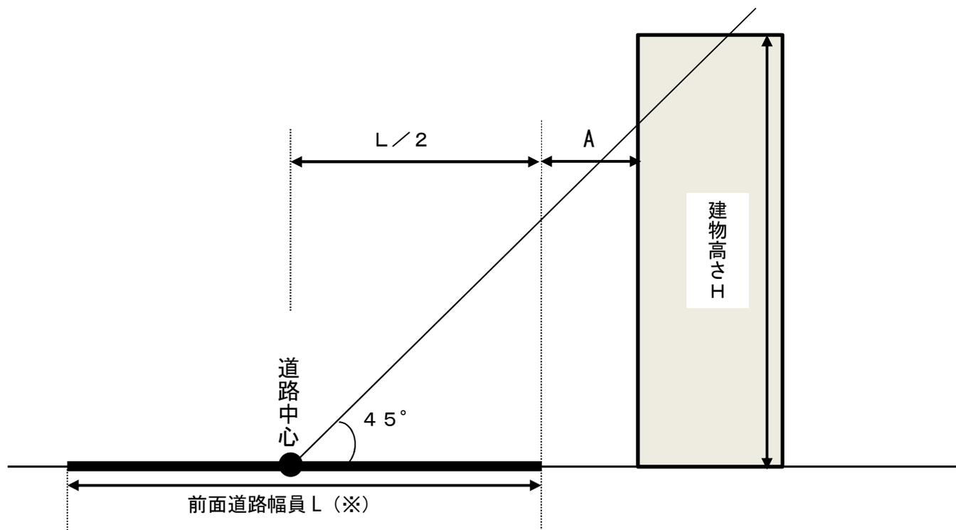
道路幅員 (L) の 1/2 にセットバック距離 (A) を足した高さを超える建築物
