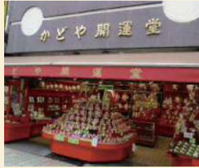
▲1階部分は開口部を広くとり、店内を見やすくする（仲見世地区）
