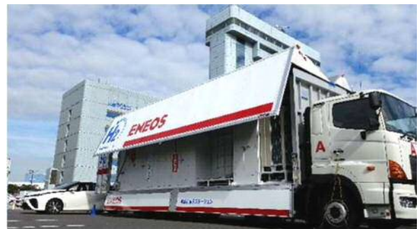
川崎マリエン移動式水素ステーション
