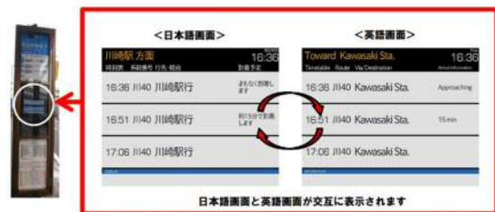
タブレット型停留所運行情報表示器
