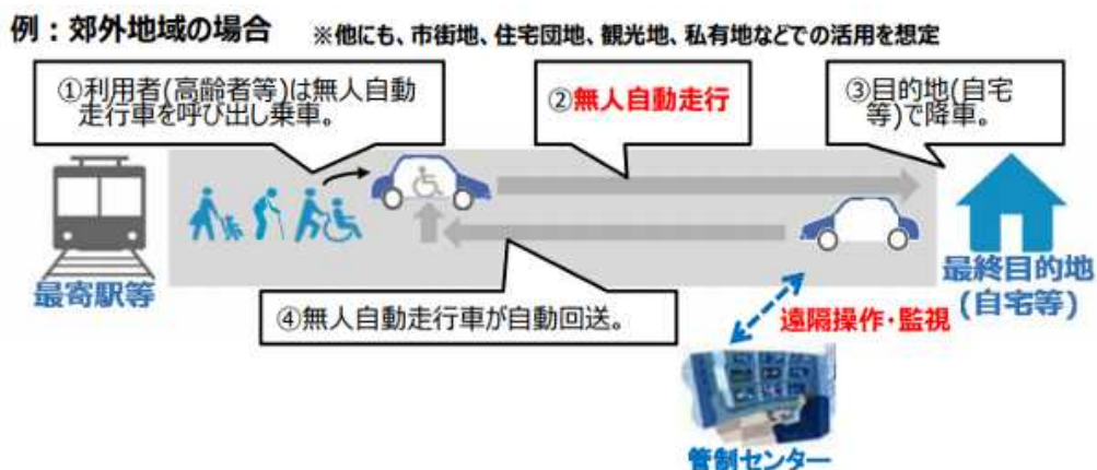
図 ラストマイル自動走行、端末交通システム
