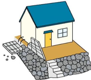
石垣や擁壁などの上の塀は、地震の揺れなどに抵抗する鉄筋が塀下に固定されていない可能性があるため、要注意です。
