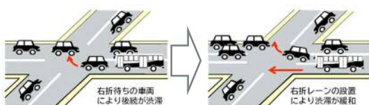
図 右折レーン整備後の交差点イメージ
