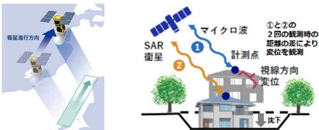
衛星 SAR による観測の仕組み (NEC 提供、一部追記)
