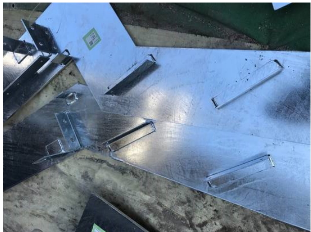
写真 1.3.5 溶融亜鉛めっきによる防錆措置の事例
