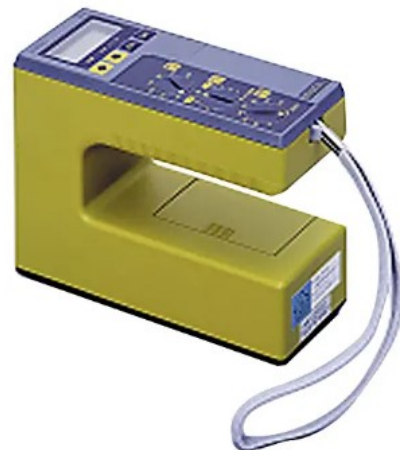
写真 2.2.3 高周波誘電率式水分計 (例)
