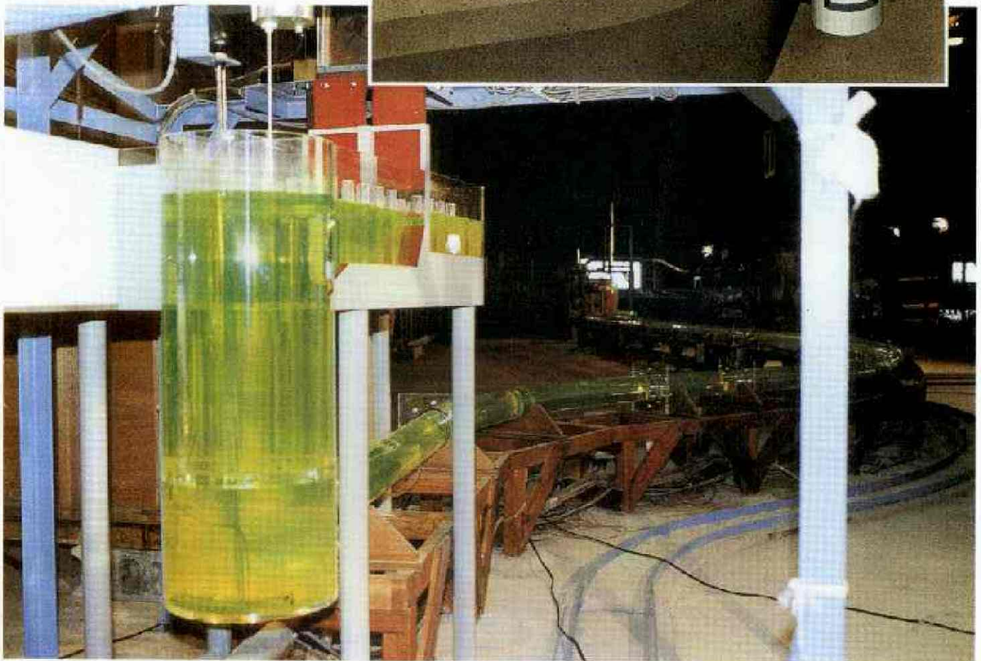
水理模型実験 縮尺1/100 (分流部より)
