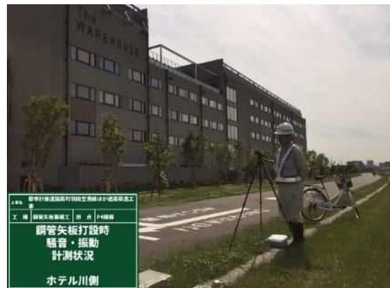
図 2.2.31 騒音振動計測状況
