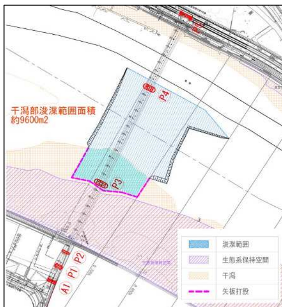
図 2.2.12 H29～H31(R1)年度工事の浚渫範囲
