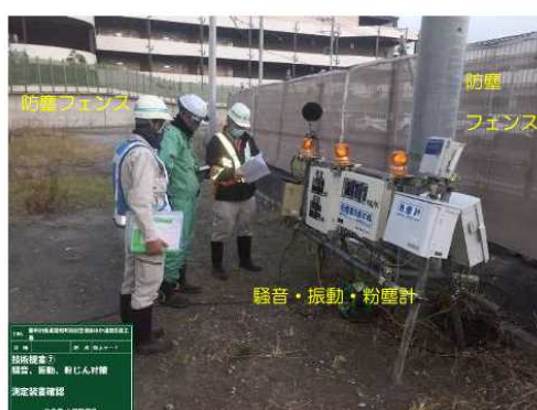
図 2.33 騒音・振動・粉塵計測（左：計測状況、右：モニタリング画面）
