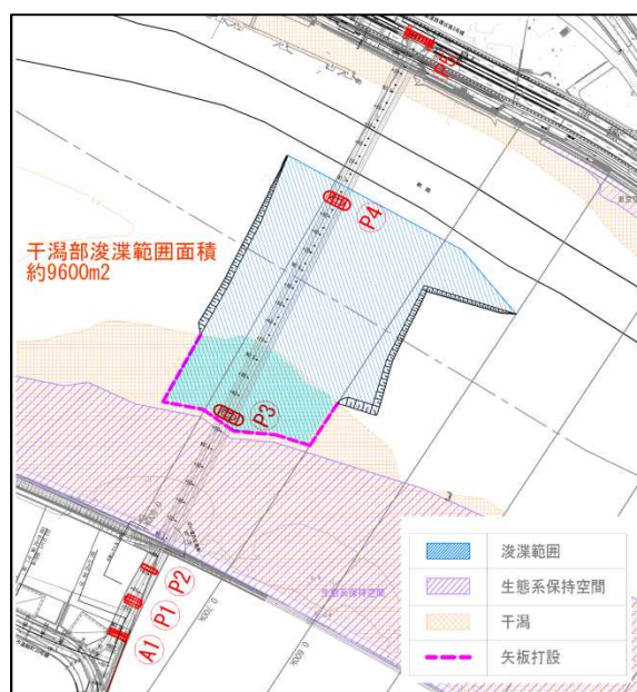
図 2.11 H29～H31 (R1) 年度工事の浚渫範囲
