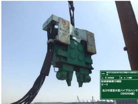
図 2.30 特殊バイブロハンマ使用（左）、低騒音型建設機械（右）
