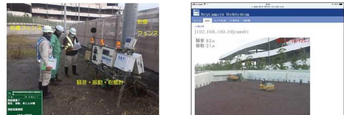
写真 2-29 騒音・振動・粉塵計測（左：計測状況、右：モニタリング画面）
