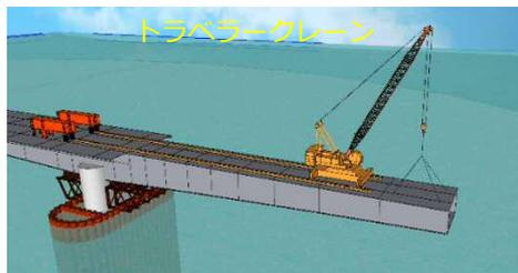
図2 トラベラークレーン工法イメージ図
