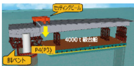
台船一括架設工法イメージ図
