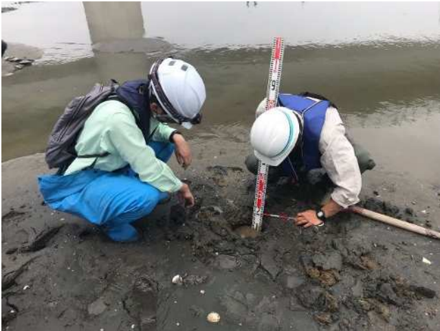
図 2.2.3-18 表土埋戻し確認状況
