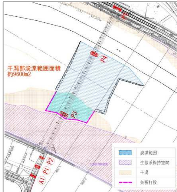
図 2.2.3-1 H29～H31(R1)年度工事の浚渫範囲
