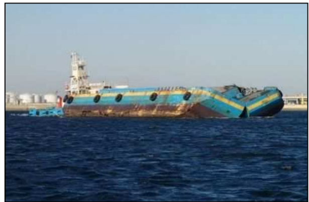
浚渫土砂投入状況（浮島処分場）
