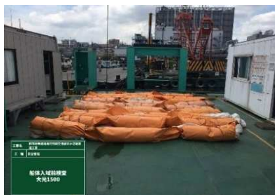
図 2.2.3-29 オイルフェンス常備状況
