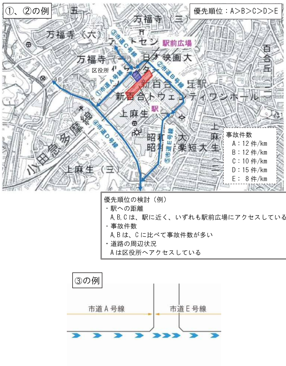
図 6-2 地域自転車ネットワーク内の路線における優先順位の考え方（イメージ）
