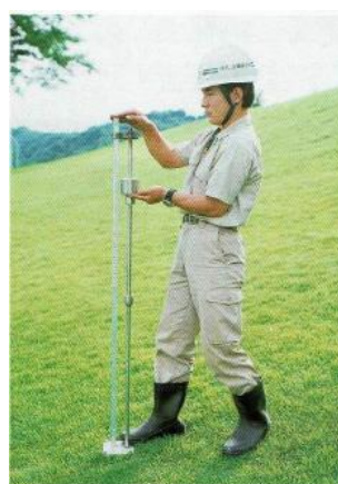
落錐を落とし探土部を土壌に貫入。
