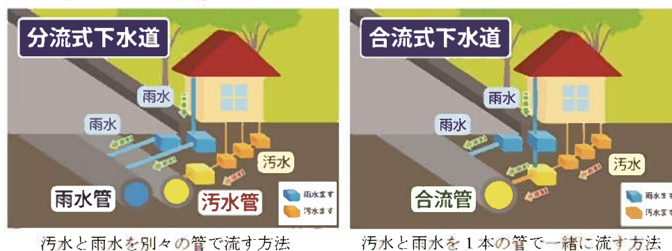
図 3-1 下水道の排除方式
