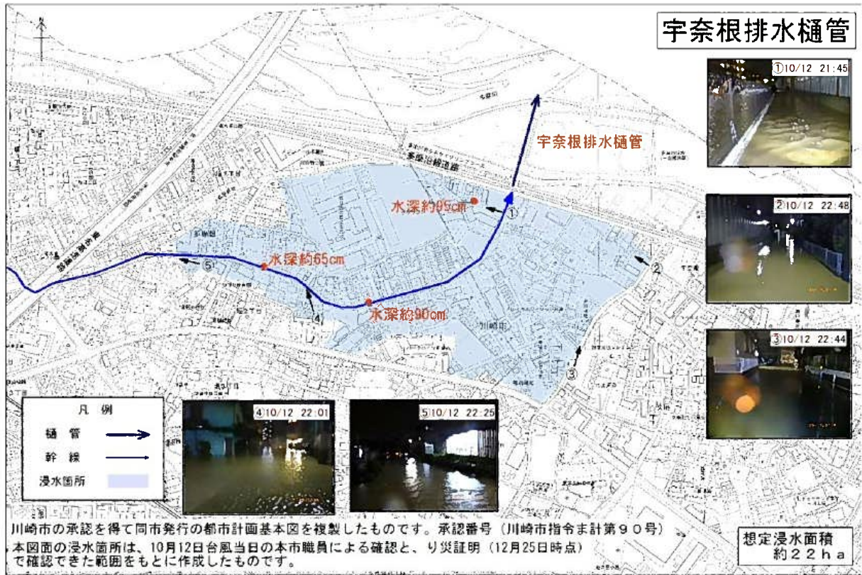
図5-5-1 令和元年東日本台風による宇奈根排水樋管周辺地域の浸水状況
