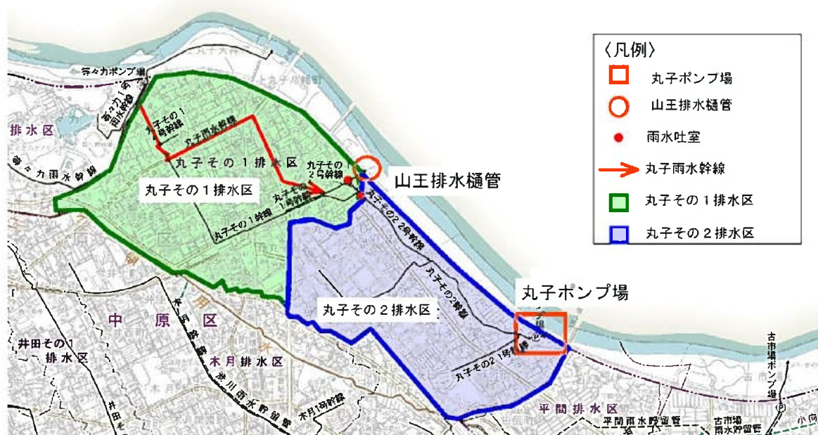
図 3-1-1 山王排水樋管周辺地域の概要図
