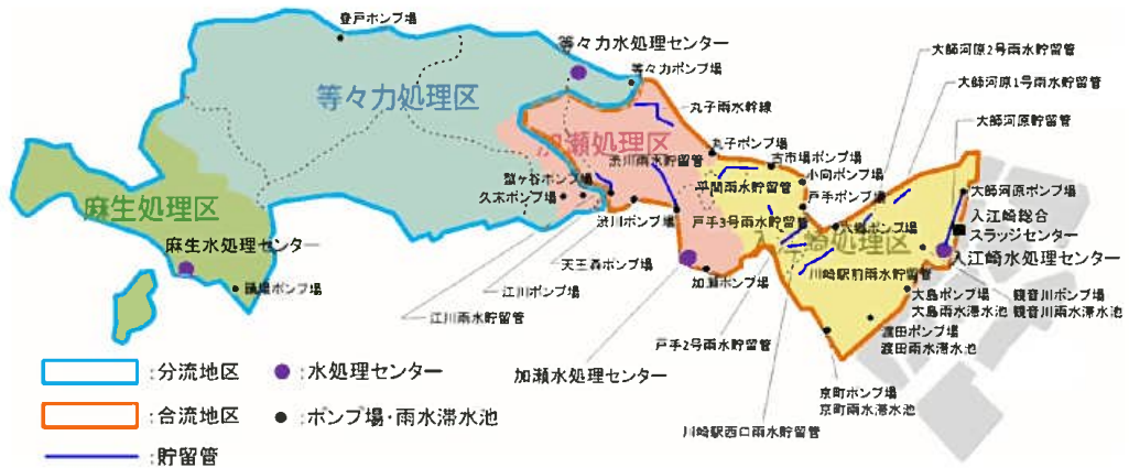
図 2-1 下水道（雨水）計画概念図
