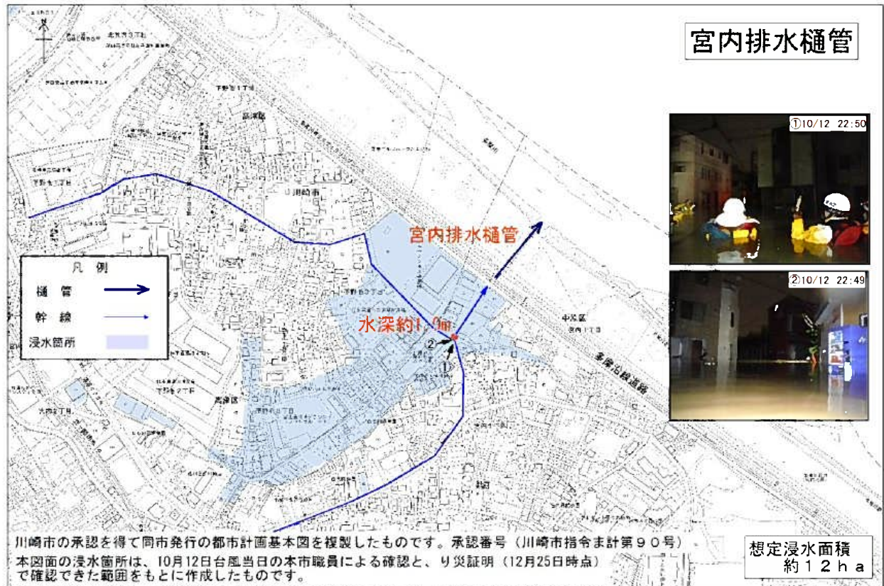
図5-2-1 令和元年東日本台風による宮内排水樋管周辺地域の浸水状況
