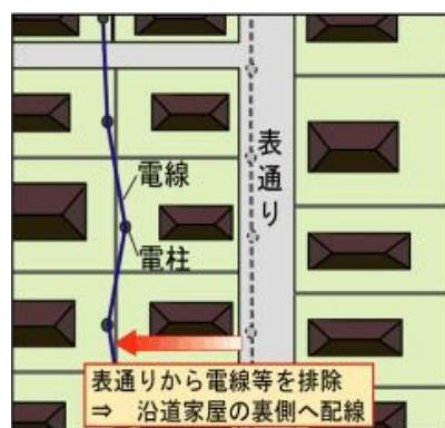
無電柱化したい主要な通りの裏通り等に電線類を配置し、主要な通りの沿道の需要家への引込みを裏通りから行い、主要な通りを無電柱化する手法です。
