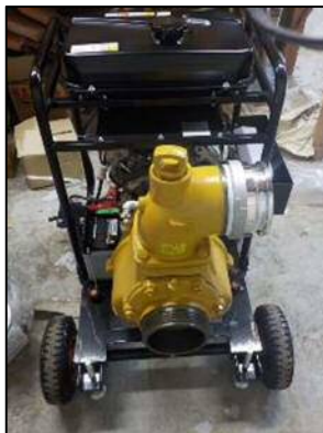
移動式ポンプ (吐出量3.3m 3 /min × 4台)
