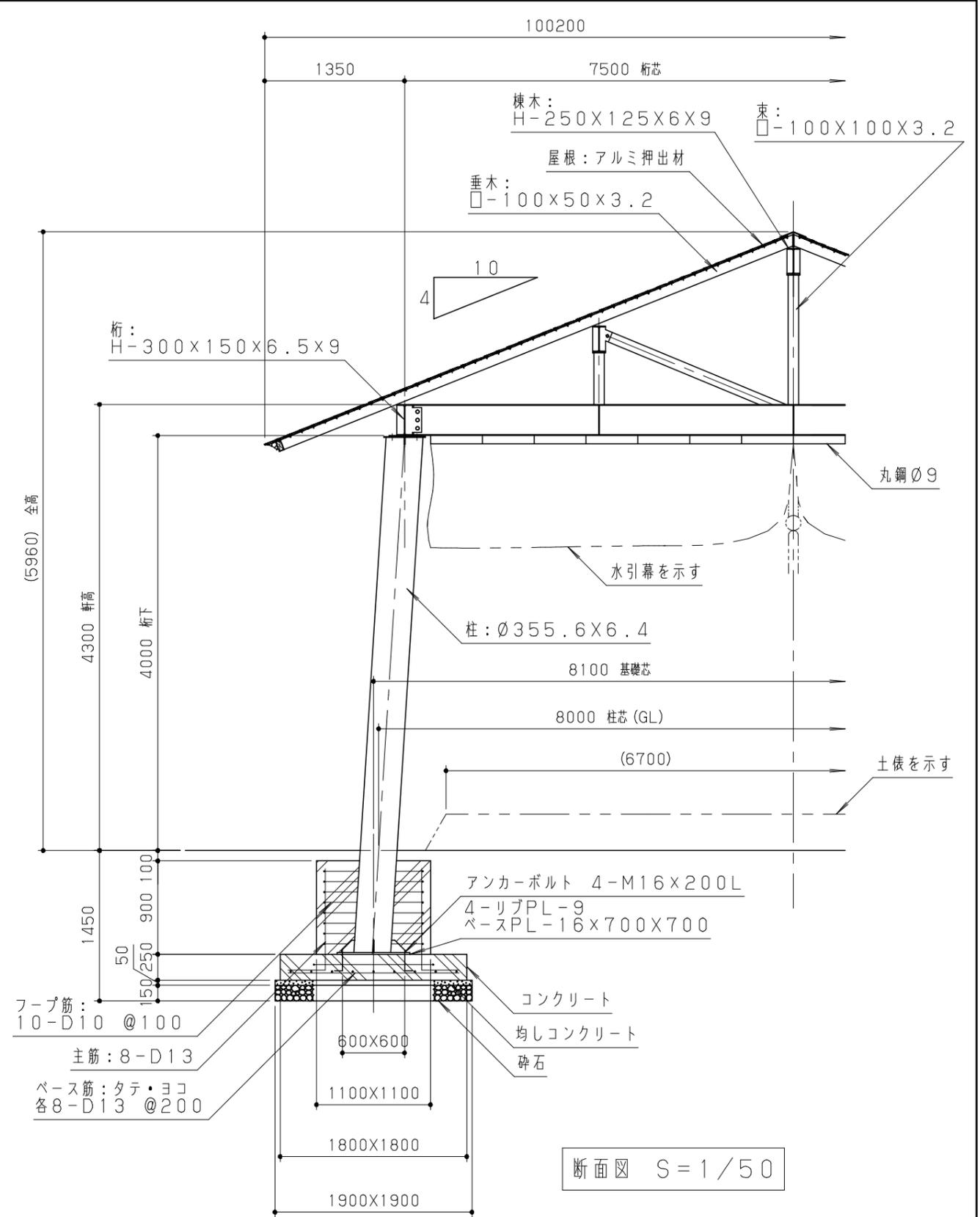
鋼材は、電気亜鉛メッキ処理の上、ウレタン樹脂塗装仕上げとする。
