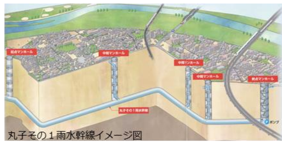
丸子その1雨水幹線イメージ図
