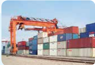
トランスファークレーン Transfer Crane
