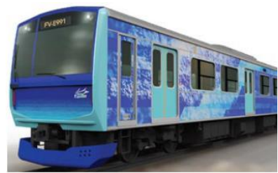
燃料電池ハイブリッド実験車両 (JR東日本・日立製作所・トヨタ自動車)
