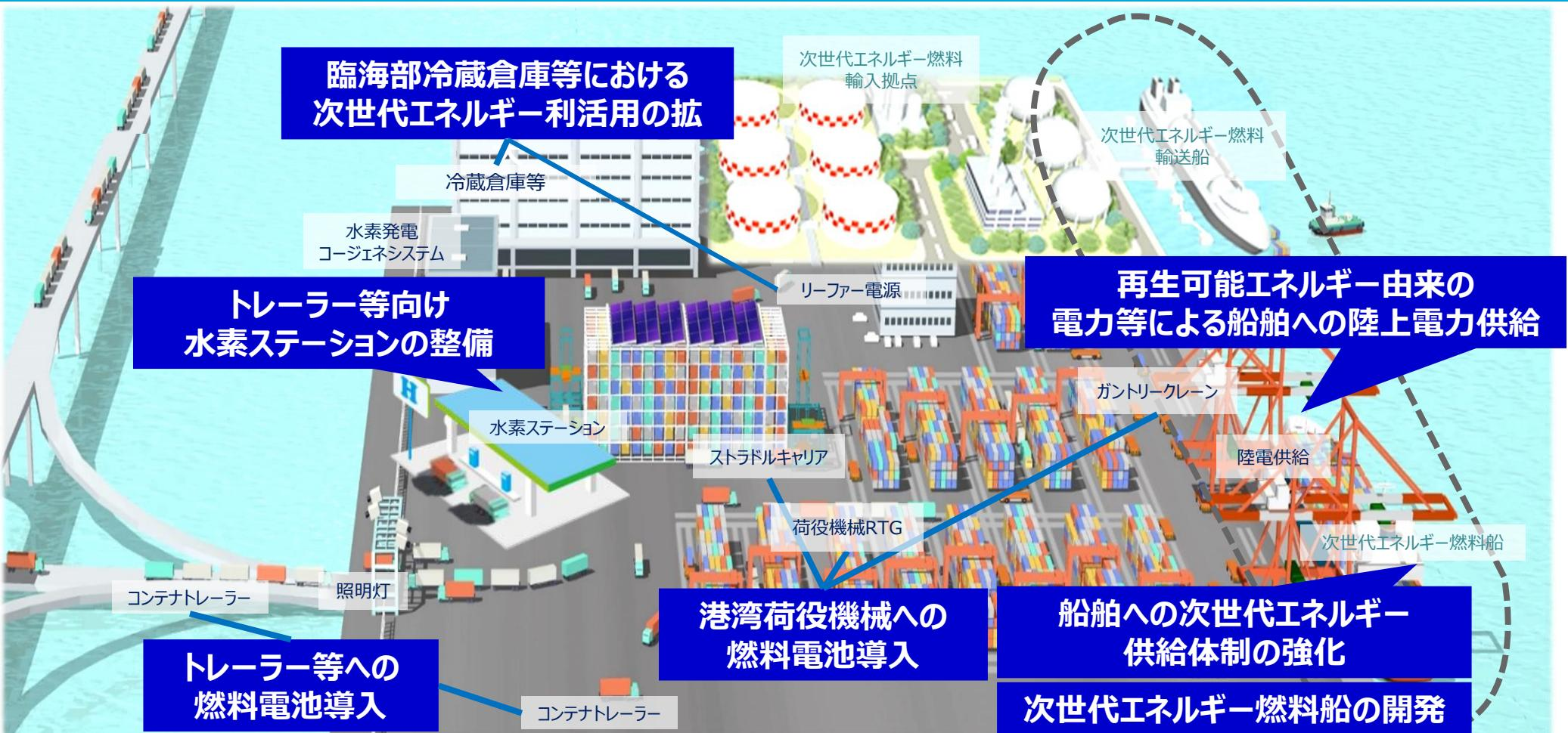
照明灯 水素ステーション コンテナトレーラーストラドルキャリア (FCV) 荷役機械RTG 次世代エネルギー 輸入拠点 次世代エネルギー 輸送船 ガントリークレーン 陸電供給 (FC)
