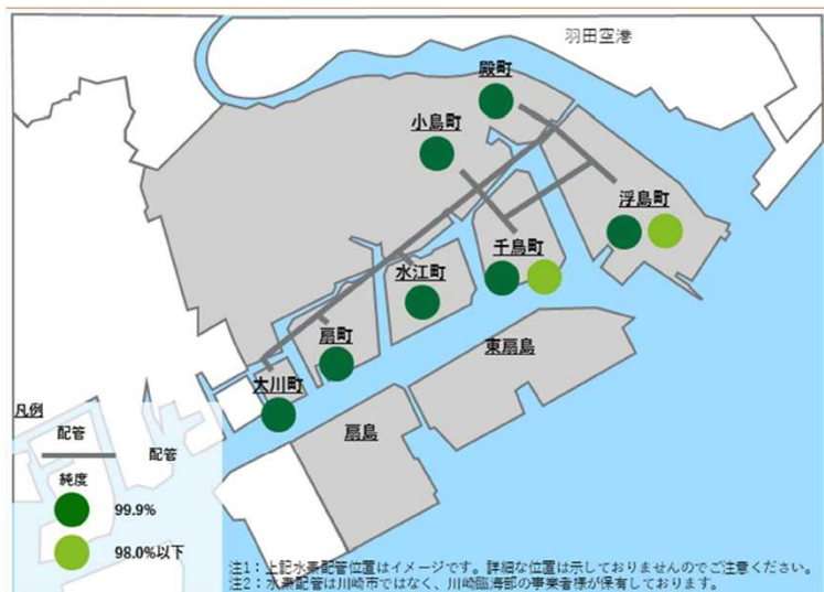
川崎臨海部水素配管
