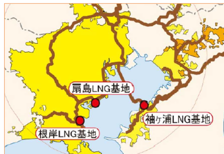
東京湾岸の高圧都市ガス導管
