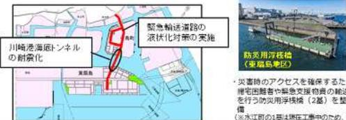
・災害時のアクセスを確保するため、増設浮橋や緊急物資輸送の輸送を行う防災用浮橋(2基)を整備(※水江可の1基は現在工事中のため、千鳥町へ仮設品)
